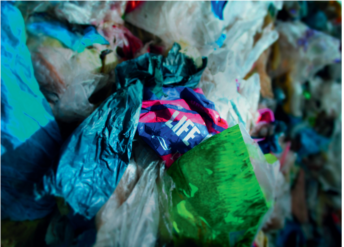
Zweites Leben aus dem Gelben Sack: Die Grundlage für den Werkstoff Hanit bilden Kunststoffabfälle aus dem Dualen System in Deutschland, die der Hersteller der Gitterbodensysteme selbst sortiert, zerkleinert und verarbeitet. © Hahn Kunststoff GmbH
